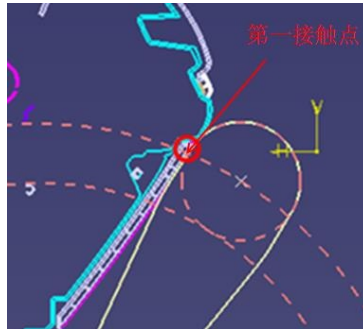
图 5 某车型乘员侧仪表板膝碰区域型面校核
