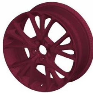
图 6 优化前轮辋仿真模型 Fig. 6 Simulation model of the rim before optimize
