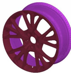
图 10 优化后轮辋模型
