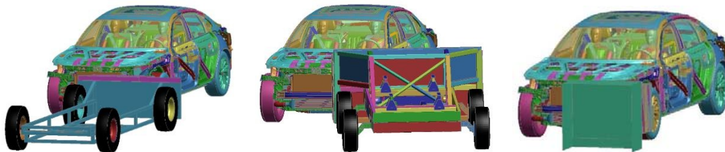
图 4 整车正面 MPDB、OMDB、ODB 碰撞仿真模型
