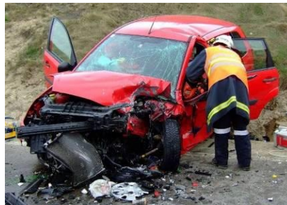
图 1 横、纵梁没有完全被撞击导致的乘员舱严重变形
