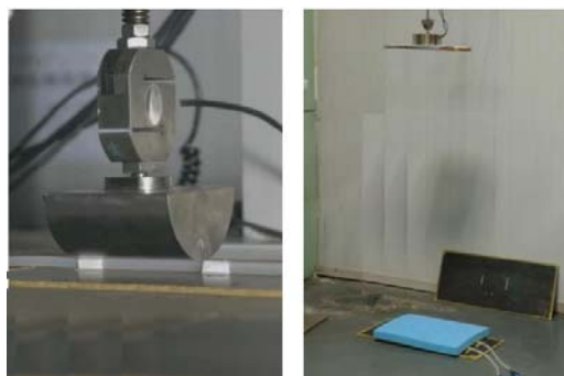
图 5 压力管试验示意（左：准静态压缩试验 右：动态跌落试验）
